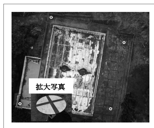
図-6 対空標識設置箇所
