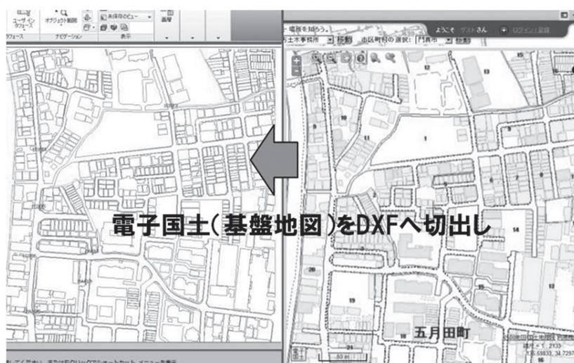
図-2 基盤地図情報の DXF 出力
