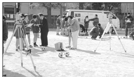
② (ボール投げ) コーナー ボールを投げ歩測での距離と(光波測距機)で測った距離の差を求める
